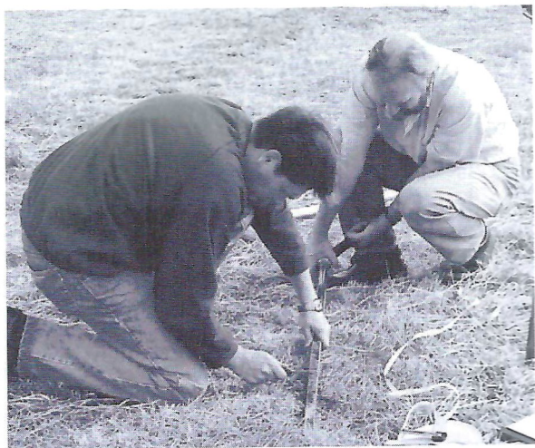
Bild 4: Mit einem Messer wird die Erde in der Stange geglättet.
